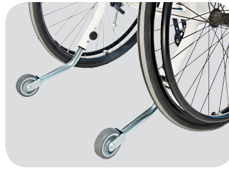
Podpory przeciwywrotne zapobiegają przed przewróceniem się wózka.
