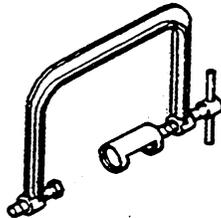
**OIL PUMP OIL SEAL INSTALLER**
