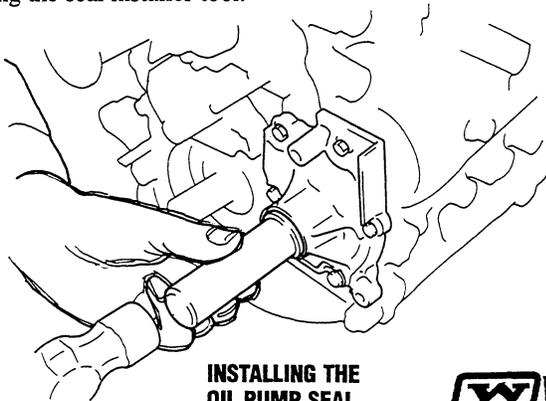
INSTALLING THE OIL PUMP SEAL
