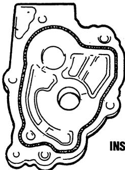
INSTALLING THE GASKET
