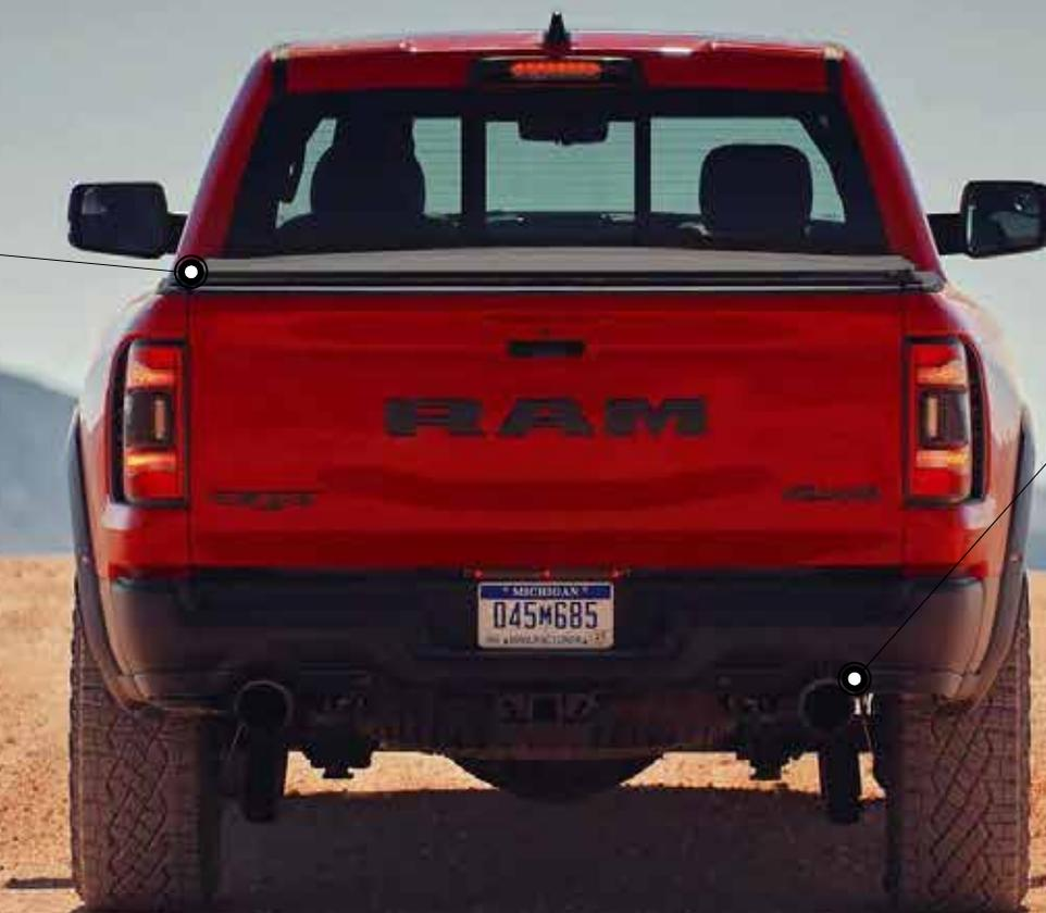
El escape utiliza dos tubos sin resonancia para emitir un gruñido apasionante desde las enormes puntas de escape de color negro mate de 5 pulgadas.
