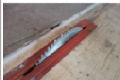
(1) 圆锯切割机，金钻石锯片2毫米。
