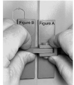
Con el pasador de alineación instalado, retire el revestimiento de la cinta de transferencia de la parte posterior de ambos accesorios. Coloque la Figura A (receptor hembra) en la cubierta del panel fijo, a lo largo del borde adyacente a la puerta de acceso al disyuntor. Luego, coloque la Figura B en el borde de la puerta de acceso al disyuntor. Presione firmemente para asegurar ambos accesorios.
