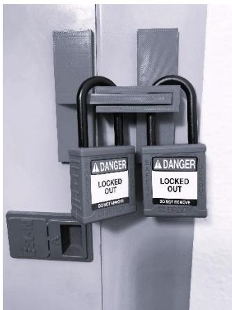
Nota: Fije el receptor de doble pata a la superficie fija (sin bisagras). Fije el accesorio de una sola pata a la cara de la cubierta con bisagras. El accesorio de una sola pata se cierra entre el canal de doble pata cuando la cubierta está cerrada y permite la conexión de uno o varios candados.
