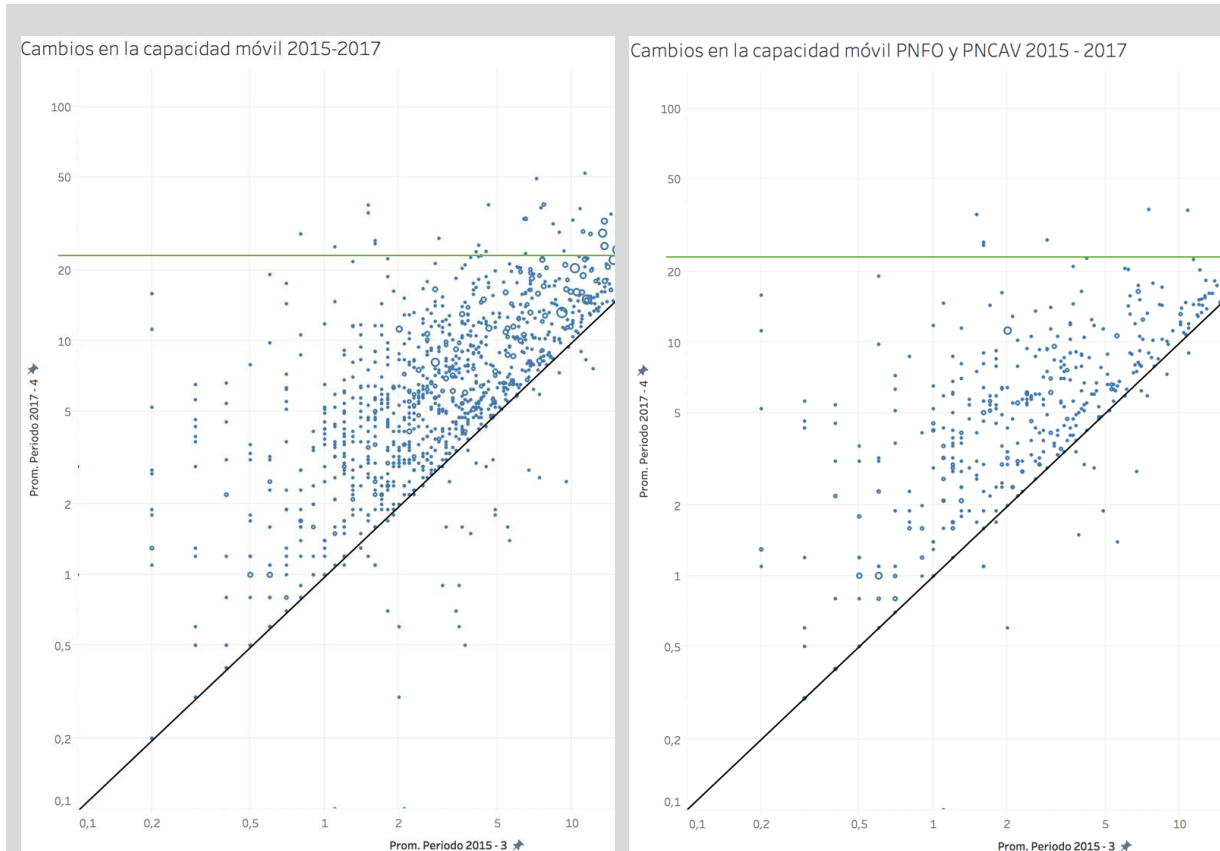
Figura 4.24 – Comparación de la capacidad agregada de las redes móviles (GSM, UMTS, HSPA, LTE) para los municipios del país (izquierda) y para los municipios beneficiados por el PNFO (derecha) – año 2015 vs 2017 [kbps/persona]
