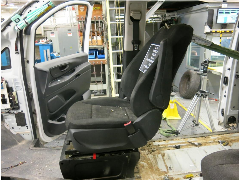
5. S4.2(d) Moment load test – pre-test
