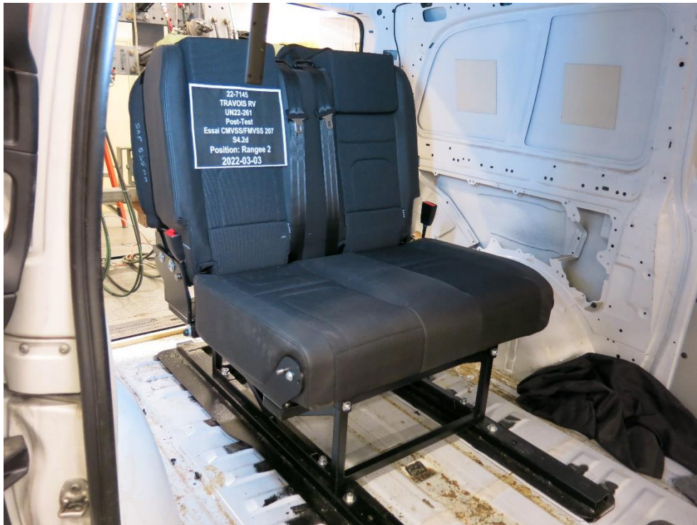
18. S4.2(d) Moment load test – post-test
