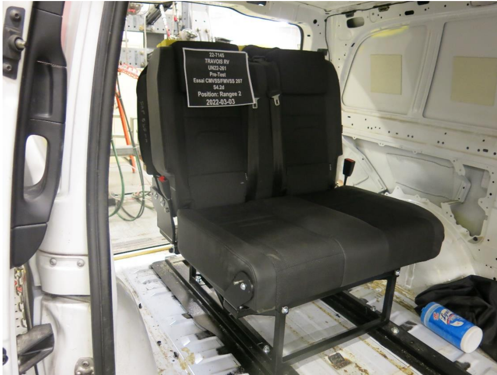
17. S4.2(d) Moment load test – pre-test
