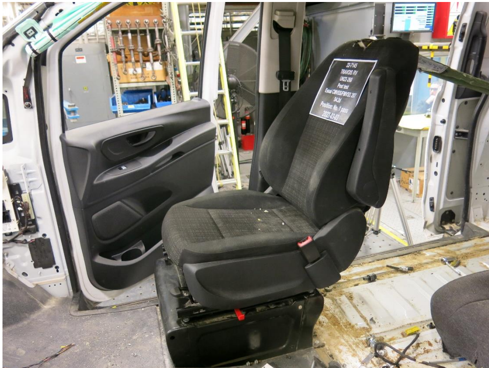
6. S4.2(d) Moment load test – post-test
