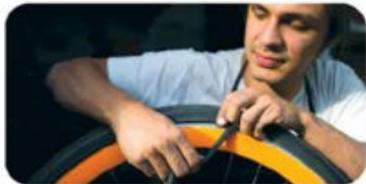
**6** Al final utiliza los desmontadores evitando morder la cámara (ocurre cuando el desmontador atrapa la cámara contra el rin). Infla con la presión indicada en la llanta.
