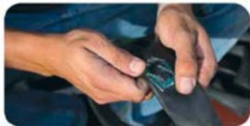
**5** Antes de meter la cámara revisa, con cuidado, que no esté el objeto que causa la pinchadura. Al meter la cámara empieza por la válvula, monta la llanta al rin, al principio, con las manos.
