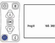
3. Usando las flechas hacia arriba o hacia abajo, encontrara la opción 2, "TEST PLAN", presione "OK" para seleccionar. La opción de plan de pruebas (TEST PLAN) comenzara a parpadear.
