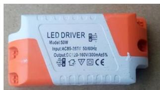
Balastras: con 2 balastras de 50 w de 6 cm de largo por 2.9 ancho y grosor de 1.9 cm con las siguientes características nominales: input ac 85-265v 50/60hz output dc 120-160v/300mA +-5%. Características generales: reflector LED de luz blanca fría. Color de temperatura de 6, 500 K. 7,000 Lúmenes. Tiempo de vida útil estimado de 30,000 hrs. Características eléctricas AC 100 – 245 V~ 50/60 Hz. Cuenta con IP66. No produce rayos UV o IR.
