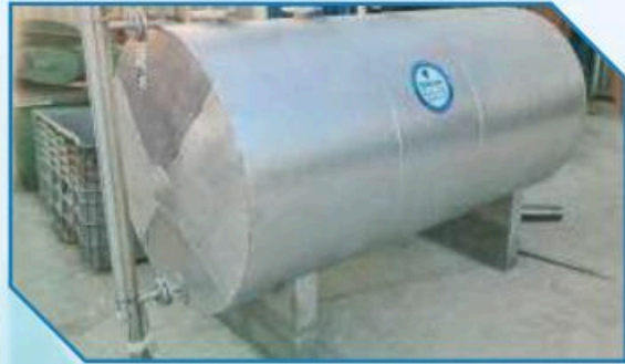
İzoleli Kondens Tankı (MKE-KIRIKKALE) - 5 ton Isolated Condensate Tank (MKE-KIRIKKALE) - 5 ton
