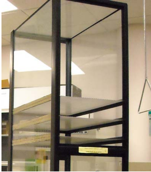
Figure 6. Center diffusion baffles
