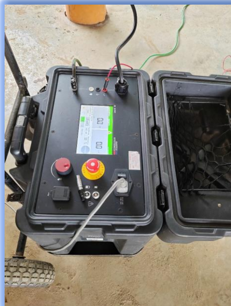
SERVICIO DE CERTIFICACION DE GUANTES Y PERTIGAS EPP, 40KV, CELSIA PANAMA
