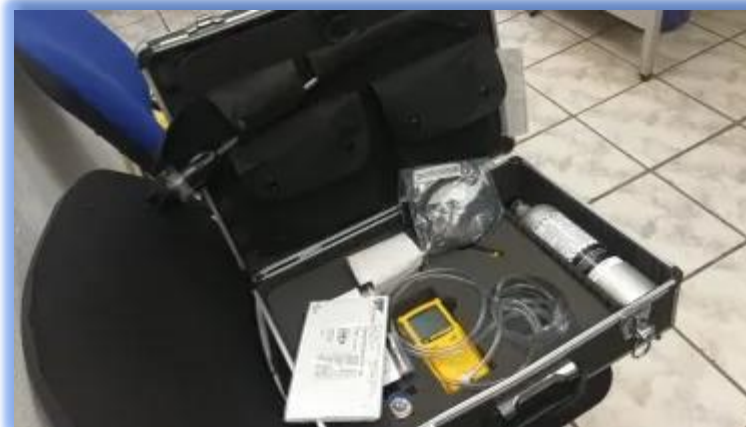
SISTEMA PARA DETECCIÓN DE GASES EN ESPACIOS CONFINADOS, SELCHI
