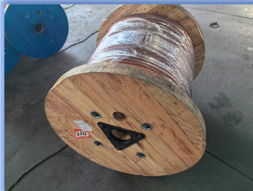
ALAMBRE 7 #2AWG COBRE PARA ATERRIZAJE PARA POSTES, LINEA PROY. SOLAR PANAMA
