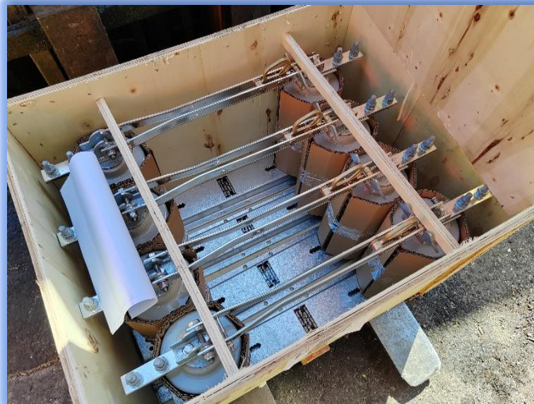
CUCHILLAS MONOPOLARES 900 AMP, 35KV, PROY. SOLAR, CHIRIQUI, BTU ENERGIA
