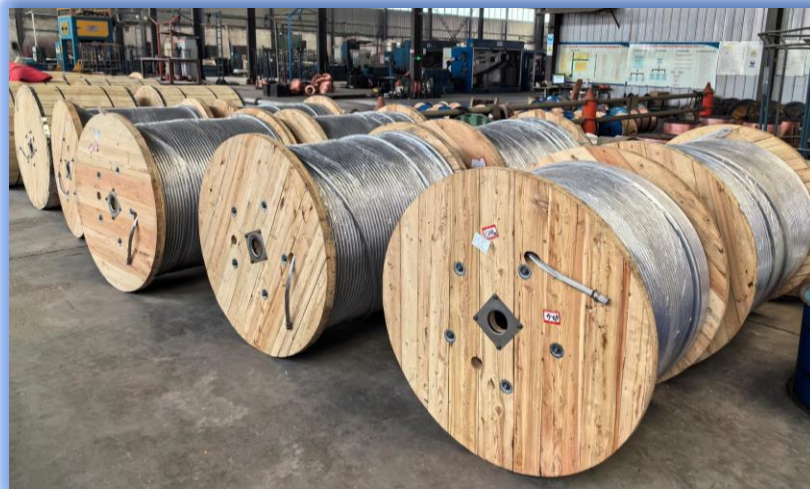
ORIOLE ACSS 336.4KCMIL – LINEA DE 35KV PROYECTO SOLAR PANAMA
