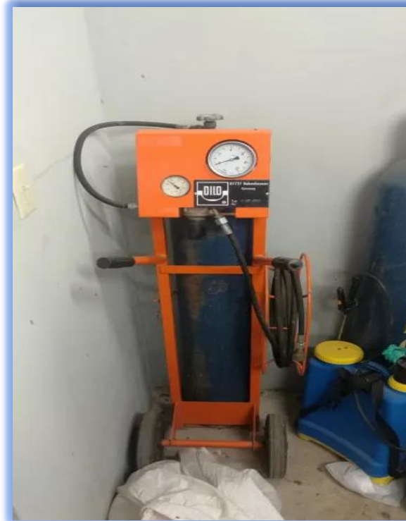
MAQUINA PARA RECIRCULACION DE ACEITE EN TRANSFORMADORES
