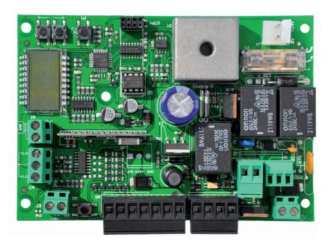
Centrale di comando per motori Hercules a 24V
