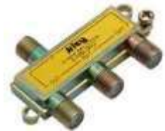
1 ENTRADA Y 3 SALIDAS PARA VIDEO DE 5 A 1000MHZ CÓDIGO: DIV-003
