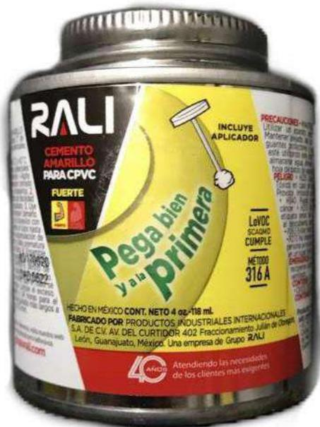
Cemento amarillo de media viscosidad para usar en toda clase de conexiones de CPVC de hasta 2" de diámetro. Para uso en sistemas residenciales de agua caliente y fría de hasta 70 °C. Recomendado para aplicación en temperaturas de 5 °C a 43 °C. Cumple con la norma ASTM F493.
