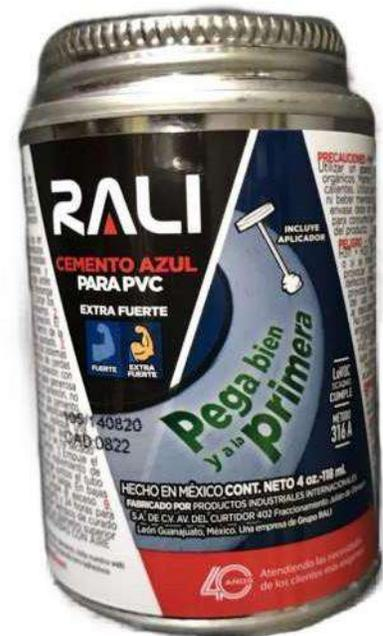
Cemento azul de alta viscosidad para conexiones de PVC hasta 8"/200 mm de diámetro. Pega rápidamente. Recomendado para tuberías de agua potable, a presión, drenaje sanitario, de desperdicio y ventilación. Se puede aplicar a temperaturas de 5 °C a 43 °C. Cumple con la norma ASTM D2564.
