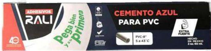
Cemento AZUL de ALTA viscosidad para usar en toda clase de conexiones de CPVC de hasta 2" de diámetro. Para uso en sistemas residenciales de agua caliente y fría de hasta 70 °C. Recomendado para aplicación en temperaturas de 5 °C a 43 °C. Cumple con la norma ASTM F493.
