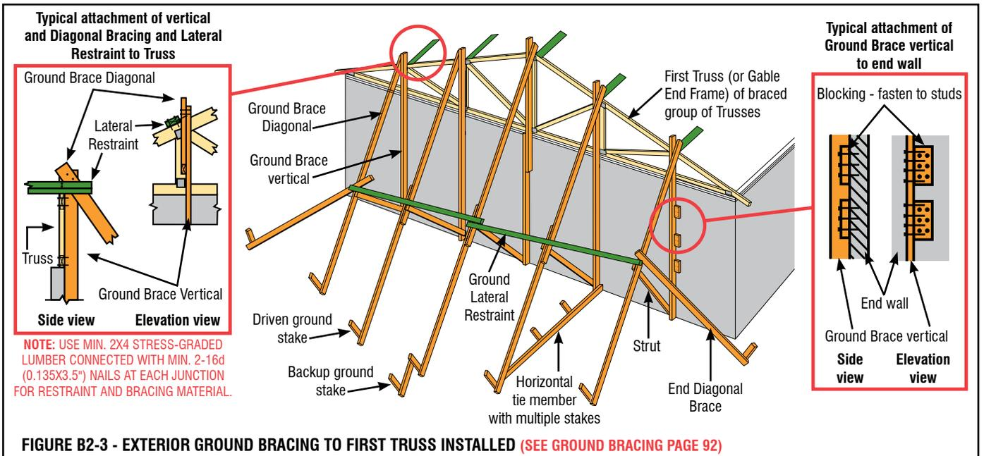
FIGURE B2-3 - EXTERIOR GROUND BRACING TO FIRST TRUSS INSTALLED (SEE GROUND BRACING PAGE 92)
