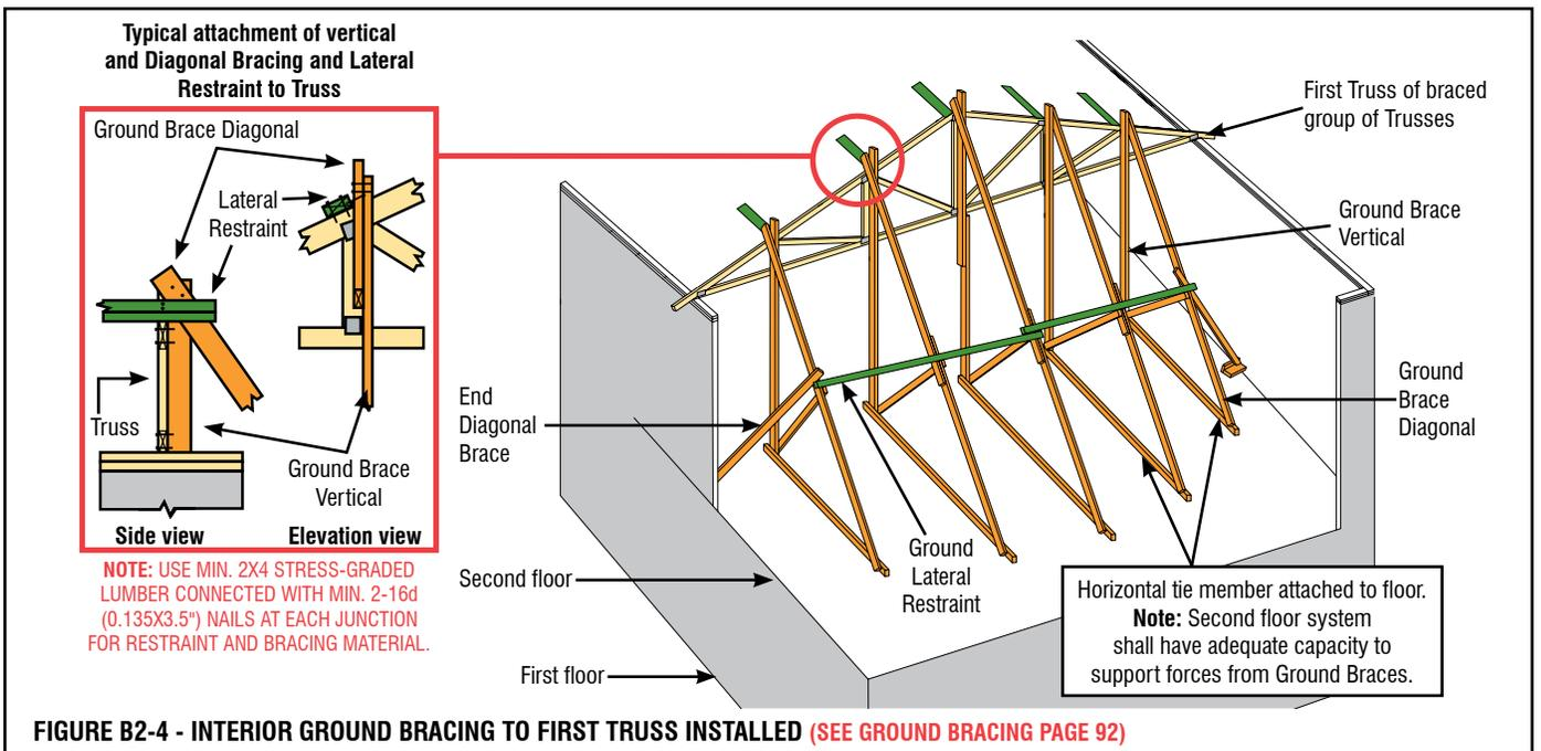
FIGURE B2-4 - INTERIOR GROUND BRACING TO FIRST TRUSS INSTALLED (SEE GROUND BRACING PAGE 92)
