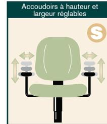
**S** Permet de monter ou d'abaisser les accoudoirs, ou de les déplacer vers l'intérieur ou vers l'extérieur selon une plage déterminée pour les adapter aux diverses tâches.
