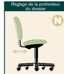
**N** Permet de régler le dossier vers l'intérieur et vers l'extérieur pour en accroître la profondeur.
