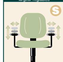
**S** Permet de monter ou d'abaisser les accoudoirs, ou de les déplacer vers l'intérieur ou vers l'extérieur selon une plage déterminée pour les adapter aux diverses tâches.
