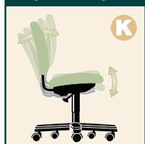
**K** Permet de régler et de verrouiller l'angle du siège et du dossier de manière indépendante.
