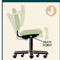
**J** Permet de régler l'angle du siège et du dossier de façon indépendante au moyen d'un seul levier.
