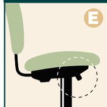
**E** Permet de régler la résistance de l'inclinaison ou du basculement de la chaise.
