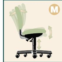
Comprend un mécanisme de pivotement/ basculement avec contrôle de la tension, un siège à réglage indépendant, réglage de l'inclinaison du dossier avec blocage à l'infini (dans toutes les positions) et réglage de l'inclinaison vers l'avant.
