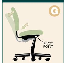
**G** Permet d'incliner la chaise à un angle plus naturel que le réglage traditionnel du basculement. Le point de pivotement de la chaise est placé légèrement vers l'avant de la chaise.
