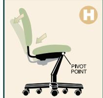
**H** Permet d'incliner complètement le siège, tout en gardant les pieds confortablement sur le plancher. Le point de pivotement est placé près de l'avant du siège.
