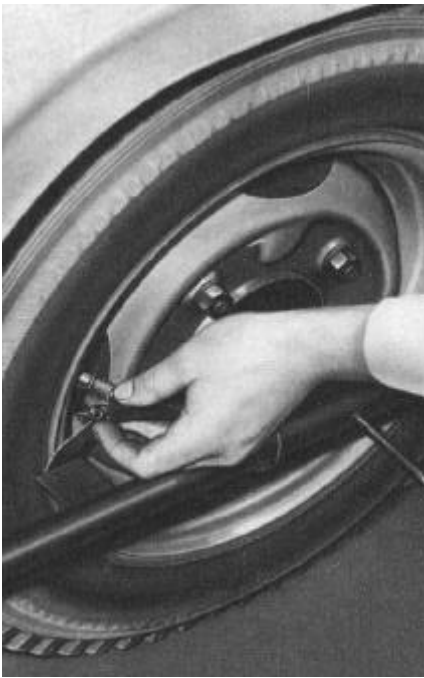
Bild F 27. Hinterräder- Vorspur überprüfen
