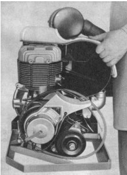
Bild M 13. Kühlluftgehäuse abnehmen
