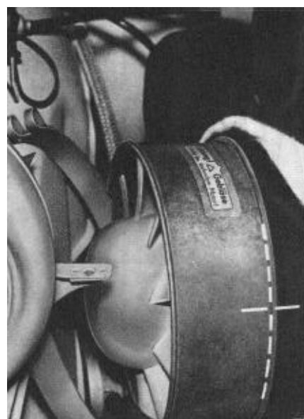
Bild M 47. Axiallüfter markieren
