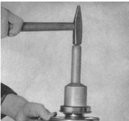
Bild M 28. Kugellager aufschlagen
