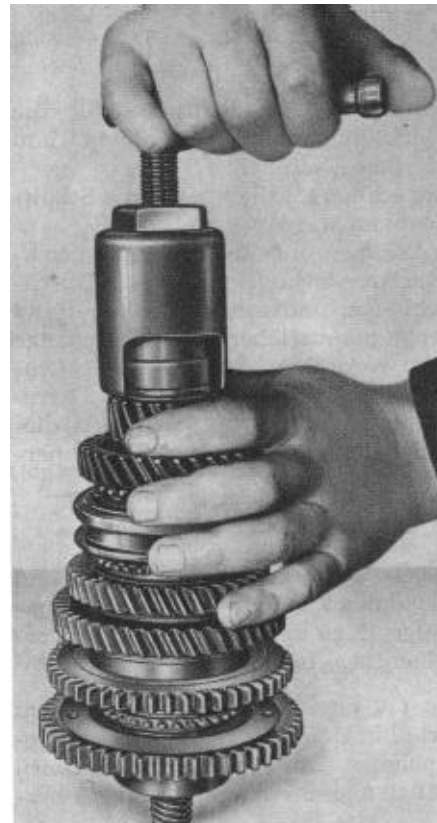
Bild G 16. Innenring vom Zylinderrollenlager abziehen
