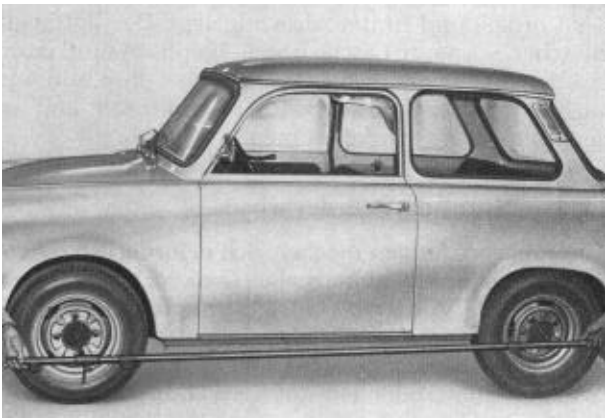
Bild F 22. Radstand überprüfen
