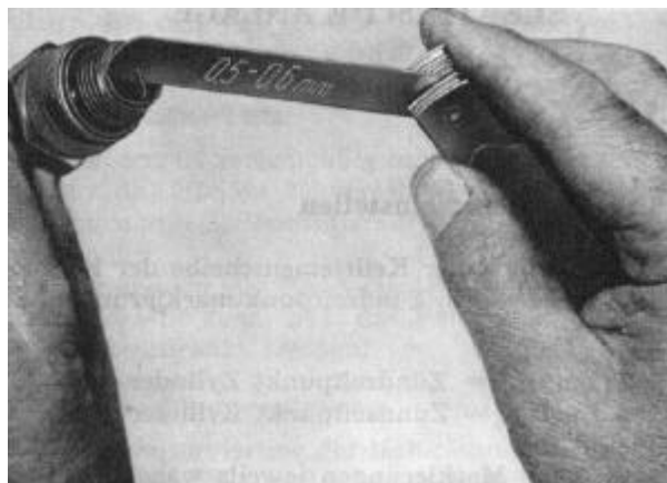
Bild E 4. Elektrodenabstand überprüfen
