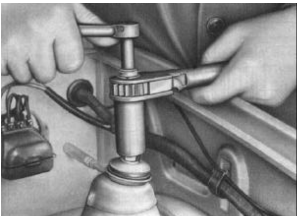
Bild F 38. Stoßdämpferbefestigung lösen
