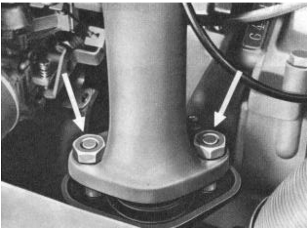
Bild M 8. Vorschalldämpfer abschrauben
