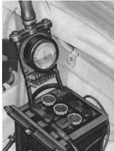
Bild E 13. Batteriespannung überprüfen
