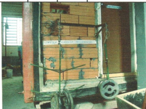
Foto n° 04 – Ensaio de carga suspenso
