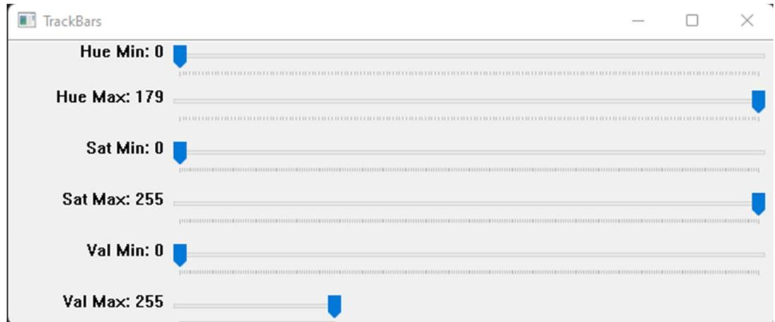
Abb.: 81 Trackbars Kalibrierung, zum Einstellen der HSV-Werte für die Filter
