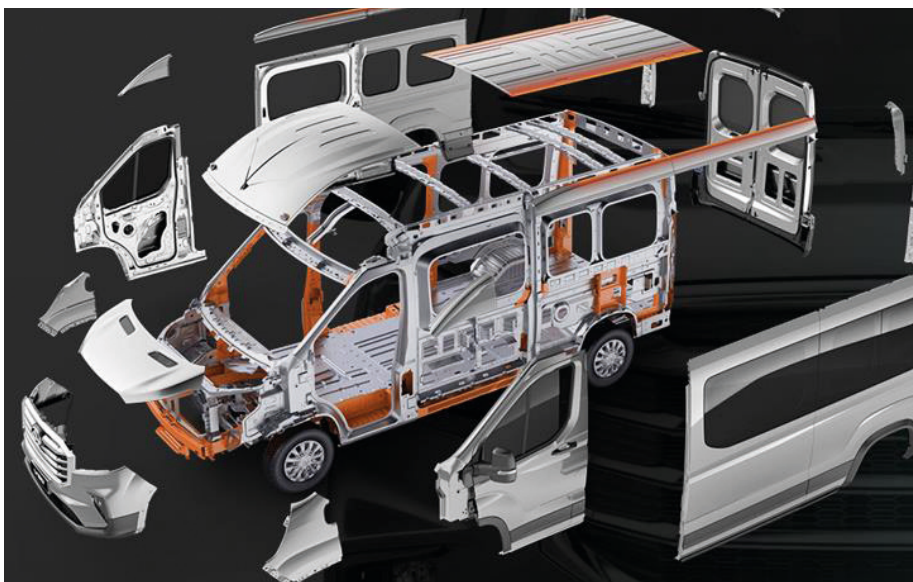
Sicherheitskarosserie aus verstärktem und hochfestem Stahl
