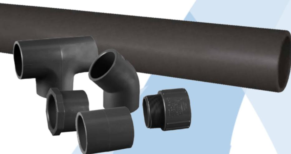
Las tuberías de PVC cédula 80 están diseñadas principalmente para conducción de agua a presión y uso industrial, su sistema de unión cementar garantiza su hermeticidad. Su presentación es en tramos de 6 metros de longitud extremos lisos en sistema IPS (Iron pipe size).
