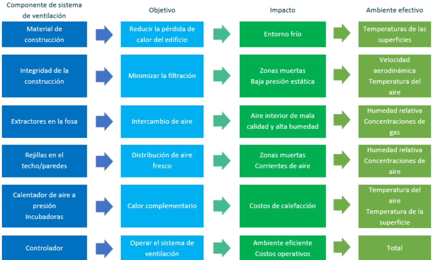
Figura 2. Relación entre los componentes del sistema de ventilación y cómo el ambiente dentro de la nave se ve afectado cuando hay clima caluroso/templado.
