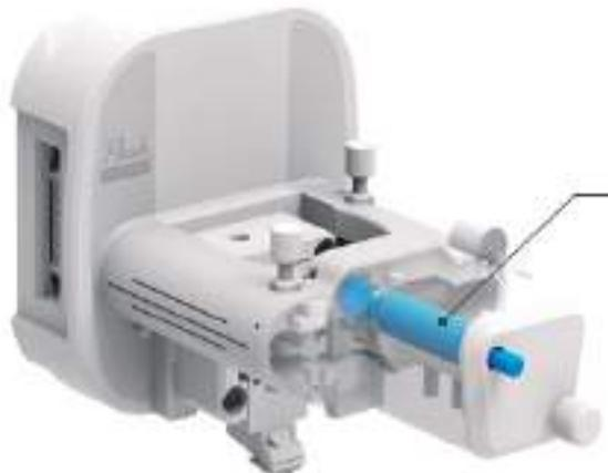
La alineación del rayo láser motorizado permite continuar con rutinas de medición automáticas sin intervención. Con nuestro avanzado soporte voladizo prealineado, el rayo láser se enfoca en el voladizo al intercambiar la punta. La mancha láser se optimiza a lo largo de los ejes X e Y mediante perillas de posicionamiento motorizadas.
