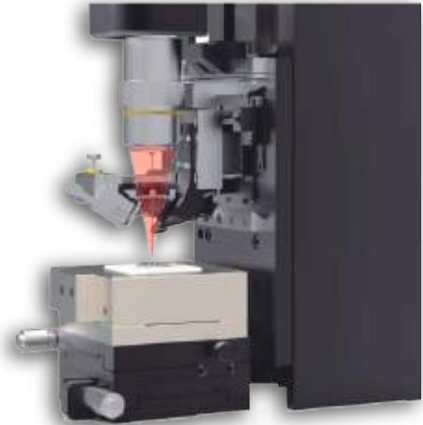
La intuitiva visión directa desde arriba en el eje de escaneo de la muestra le permite navegar fácilmente por la superficie de la muestra para encontrar el área objetivo. Una cámara digital de alta resolución con capacidad de zoom proporciona imágenes claras y de una gran calidad, independientemente del movimiento de paneo.
