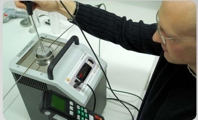
insert de superficie con sensor a calibrar, patrón externo y sensor de control externo
