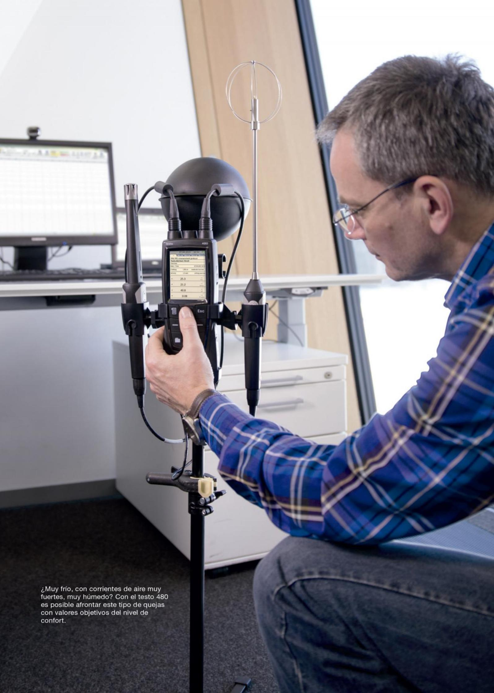
¿Muy frío, con corrientes de aire muy fuertes, muy húmedo? Con el testo 480 es posible afrontar este tipo de quejas con valores objetivos del nivel de confort.
