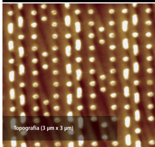
Topografía (3 μm x 3 μm)
