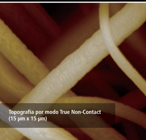
Topografía por modo True Non-Contact (15 μm x 15 μm)
