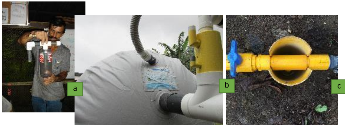
Imagen 9. Válvulas de presión utilizadas comúnmente en biodigestores flexibles. a) tubería sumergida en botella de plástico con 10 cm de columna de agua (CA)*, b) válvula de alivio fabricada con PVC para uso comercial con 4 cm de CA por la empresa Viogaz, y c) válvula de alivio fabricada con PVC para uso comercial por la empresa Sistema BioBolsa.
