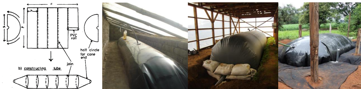
Imagen 2. La evolución de los biodigestores flexibles (“bolsa”, “plástico”, “estilo Taiwán”, “salchicha”) desde su creación en los 70’s a la actualidad (2018). a) conceptualización del biodigestor de bolsa 1 , b) un biodigestor tipo Taiwán realizado por Endev-Bolivia de la GIZ y CIPCA 2 , biodigestor en geomembrana de PVC de la empresa Viogaz 3 , y biodigestor en geomembrana de LDPE por la empresa Sistema biobolsa 4 .
