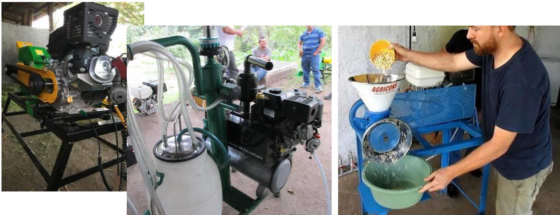
Imagen 22. Ejemplo de diferentes aplicaciones operadas con un motor operado a biogás, acoplado a diferentes usos: a) picadora de pasto, b) sistema de ordeño, y c) molino de masa.
