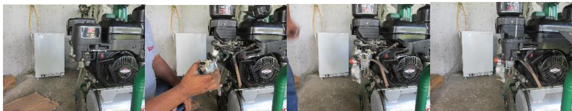
Imagen 15. Ilustración fotográfica, de los pasos para el cambio de un sistema de carburación de gasolina, por un sistema de carburación a gas, en un motor Briggs & Stratton de de 6,5 HP utilizado en un equipo de ordeño.
