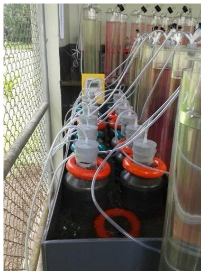
Imagen 6. Ejemplo de un set experimental donde se realiza una prueba de rendimiento de metano siguiendo la metodología de (Standard, V. D. I., 2006). Universidad EARTH.
