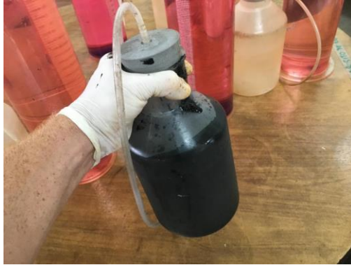
Imagen 19. Una botella de fermentación de 2 L del equipo de la Universidad EARTH, Costa Rica. Fuente: (Viquez, 2009-2017)
