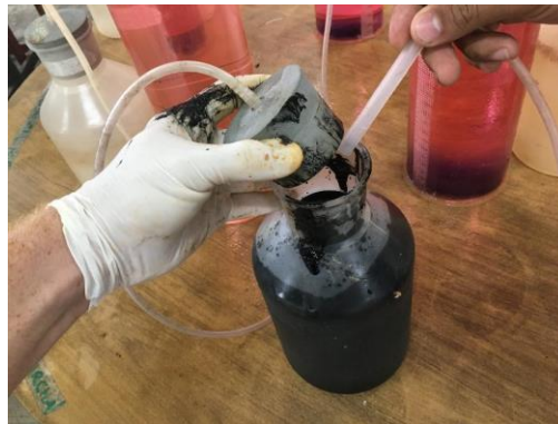
Imagen 33. “Enjuague” con nitrógeno para eliminar el oxígeno atmosférico previo a cerrar la botella para iniciar la prueba.
