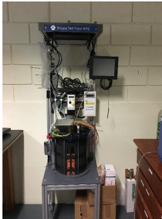
Imagen 42. Ejemplo de un fermentador complejo instalado en la Universidad EARHT en Costa Rica.
