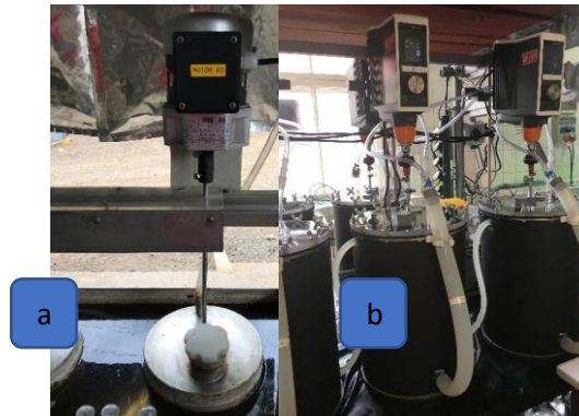
Imagen 40. Ejemplo de mecanismos para la agitación en reactores de uso continuo. a)* reactores del Instituto Costarricense de Electricidad en Costa Rica, y b)** Instituto Leibniz de Ingeniería Agrícola y Bioeconomía (ATB) en Potsdam, Alemania.
