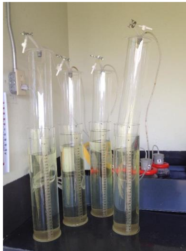
Imagen 20. Prueba de hermeticidad, aplicado al equipo de la Universidad EARTH, Costa Rica Fuente: (Viquez, 2009-2017)
