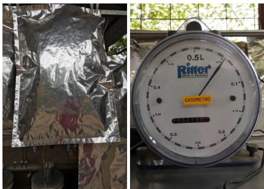
Imagen 44. Unidad para la recolección del biogás y enviado luego a un medidor. Fuente: (Instituto Costarricense de Electricidad, 2018)
