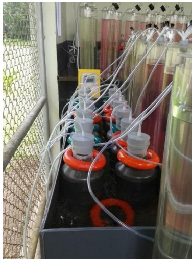
Imagen 18. Prueba de fermentación en lote en la Universidad EARTH, Costa Rica. Fuente: (Viquez, 2009-2017)
