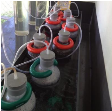
Imagen 22. Sistema de baño maría para mantener las botellas de fermentación a una temperatura constante. Universidad EARTH, Costa Rica. Fuente: (Viquez, 2009-2017)
