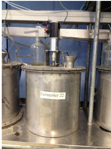
Imagen 38. Reactor para fermentaciones continuas de 5 L, instalado en la Universidad de Hohenheim. Fuente: (Viquez, 2009-2017)
