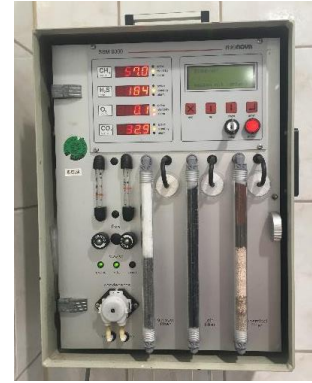
Imagen 35. Equipo para la medición del contenido de metano en el Instituto Leibniz de Ingeniería Agrícola y Bioeconomía (ATB) en Potsdam, Alemania.
