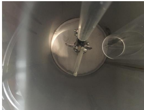
Imagen 41. Ejemplo un mecanismo para evitar la pérdida de biogás, tanto en la alimentación, como en la agitación, en un reactor en el Instituto Leibniz de Ingeniería Agrícola y Bioeconomía (ATB) en Potsdam, Alemania.
