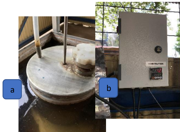
Imagen 39. Ejemplos de un mecanismo, estilo baño maría, para la calefacción de un reactor de operación continua en Instituto Costarricense de Electricidad en Costa Rica. a) se puede observar el reactor sumergido en agua, y b) es el controlador de temperatura.
