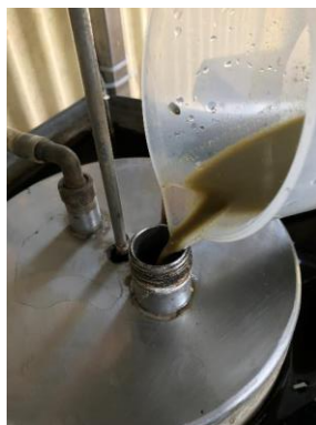
Imagen 43. Alimentación diaria al fermentador, vía una entrada en la parte superior del fermentador. Fuente: (Instituto Costarricense de Electricidad, 2018)
