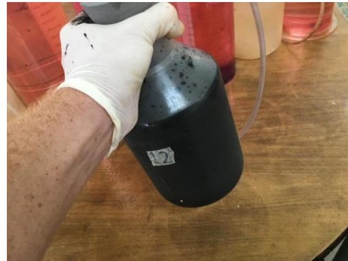
Imagen 23. Mezclado de la botella de fermentación para muestras que tiendan a formar una capa flotante. Universidad EARTH, Costa Rica. Fuente: (Viquez, 2009-2017)
