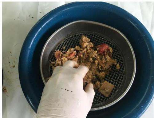
Imagen 17. Ejemplo de una estandarización del tamaño de partículas de la muestra a inferiores a 10 mm. Fuente: (Viquez, 2009-2017)
