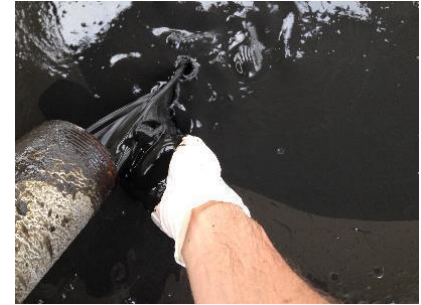
Imagen 9. Muestreo de un residuo líquido generado por una tubería. Fuente: (Viquez, 2009-2017)
