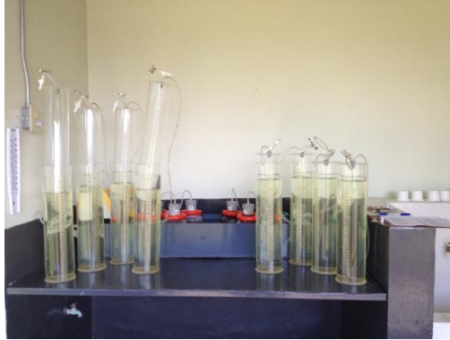
Imagen 28. Adaptación previa del inóculo a la temperatura de la prueba Fuente: (Viquez, 2009-2017)
