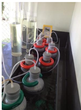
Imagen 31. Una prueba en lote, donde se tienen 3 réplicas del sustrato a evaluar y dos réplicas del inóculo. Universidad EARTH, Costa Rica. Fuente: (Viquez, 2009-2017)
