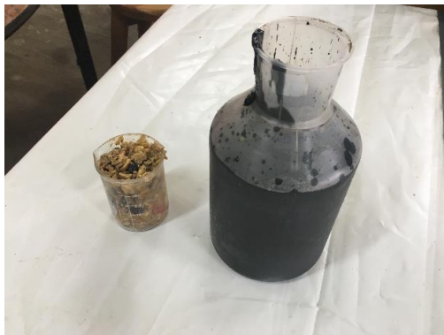
Imagen 29. Ejemplo de la proporción entre inóculo y muestra (una relación 2:1, inóculo:muestra, en base en materia orgánica seca).
