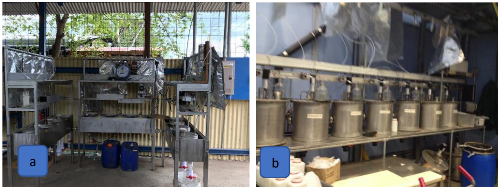
Imagen 37. Sistema de pruebas de fermentación continua: (a) En el Instituto Costarricense de Electricidad en Costa Rica, y (b) En la Universidad de Hohenheim en Alemania.
