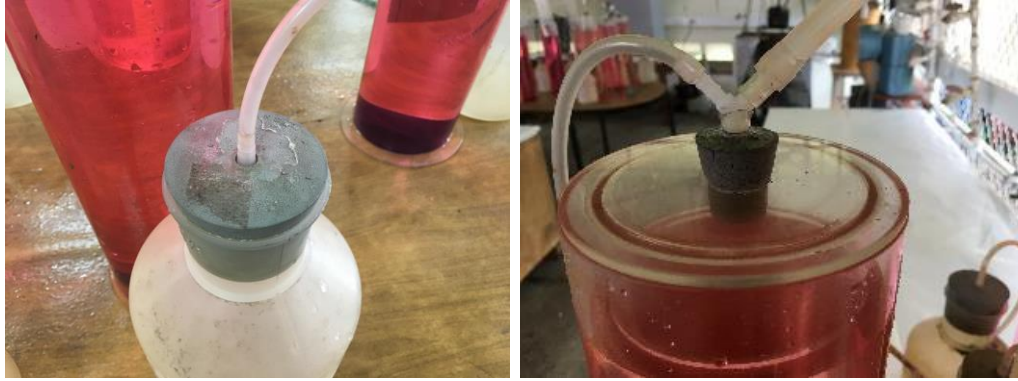
Imagen 21. Acoples de dudoso estado entre la botella de fermentación y el equipo para medición de volumen de biogás del equipo de la Universidad EARTH, Costa Rica Fuente: (Viquez, 2009-2017)
