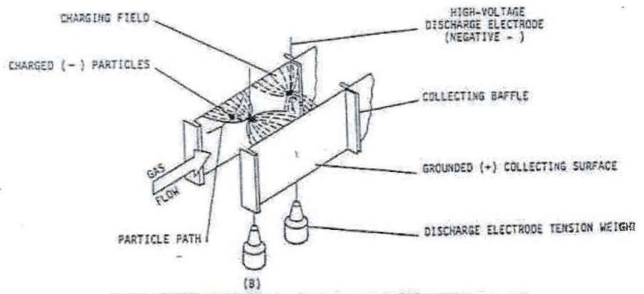
ELECTROSTATIC PRECIPITATOR ELECTRODES
