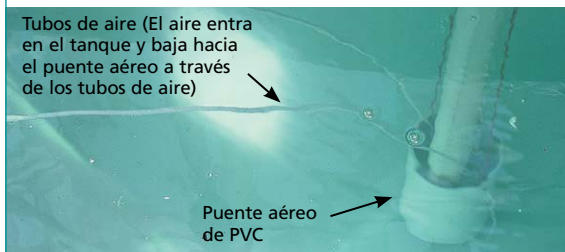
FIGURA 21 Tanque equipado con un aerodeslizador para mantener las larvas suspendidas en la columna de agua
