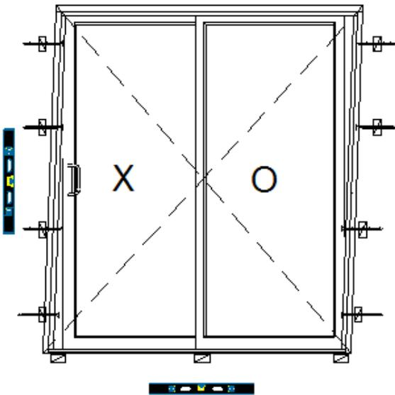
Le cadre n'est pas à niveau, ce qui causera un problème d'infiltration d'air et un mauvais fonctionnement de la porte.
