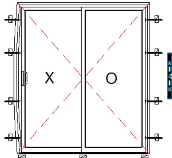
Des vis trop serrées écartent le cadre de la porte ce qui causera un problème d'infiltration d'air.
