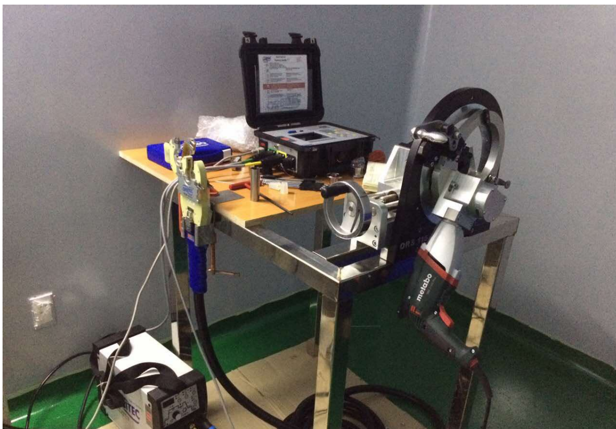
Hệ thống hàn cắt quỹ đạo Orbital Welding Hình chụp tại nhà máy dược tại Bình Dương
