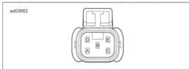
Figure A-166. Tour-Pak Lights [287]
