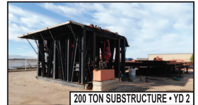
200 TON SUBSTRUCTURE • YD 2
