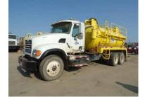
2005 MACK CHN613 T/A KILL TRUCK, P/B MACK 6 CYL DIESEL ENGINE. 18 SPD TRANS., GARDNER DENVER TEE TRIPLEX PUMP, MISSION CENT PUMP, ROPER CHARGE PUMP, SHOWS 680,032 MILES & 36,311 HRS
