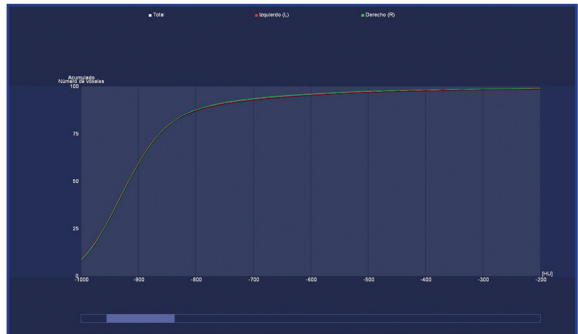
Figura 12. Histograma de frecuencias. El eje "x" indica atenuación y el eje "y" el percentil. En la gráfica se ubica el percentil 15 y se determina la atenuación correspondiente
