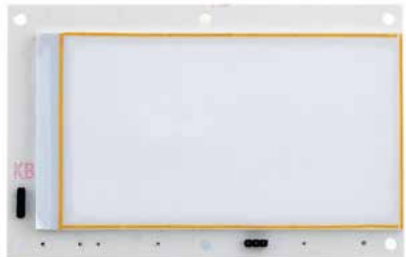
Acil Aydınlatma Göstergesi Back Light Indicators
