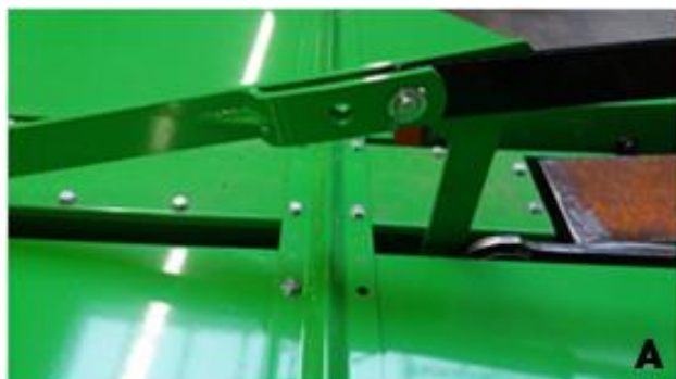
Fig. 9: Corretta installazione del cilindro idraulico sulla relativa asta. A) modello 1.85m – B) modello 1.65 Proper installation of the hydraulic cylinder in the rod assembly: A) 1.85m model - B) 1.65m model
