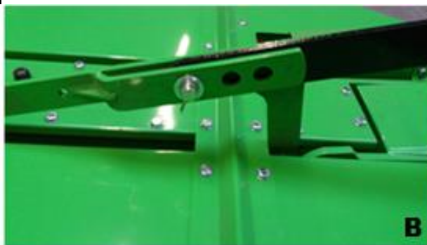
Fig. 9: Corretta installazione del cilindro idraulico sulla relativa asta. A) modello 1.85m – B) modello 1.65 Proper installation of the hydraulic cylinder in the rod assembly: A) 1.85m model - B) 1.65m model
