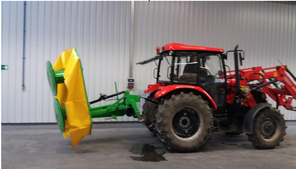
Fig. 5: Configurazione da trasporto delle falciatrici 1.85 e 1.65 nella versione con cilindro idraulico Proper transport position for 1.85m and 1.65m mowers in the hydraulic cylinder version
