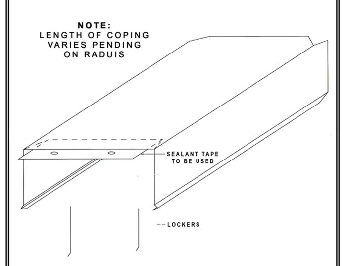
COPING-CAP FOR RADIUS PARAPET WALL
