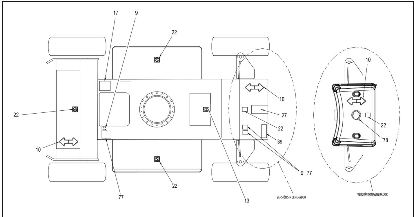
Figura 4-10. Instalación de etiquetas - Hoja 5 de 6
