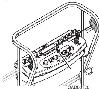
El cable está presionado, interrumpiendo la conexión magnética entre el cable y el soporte derecho.
