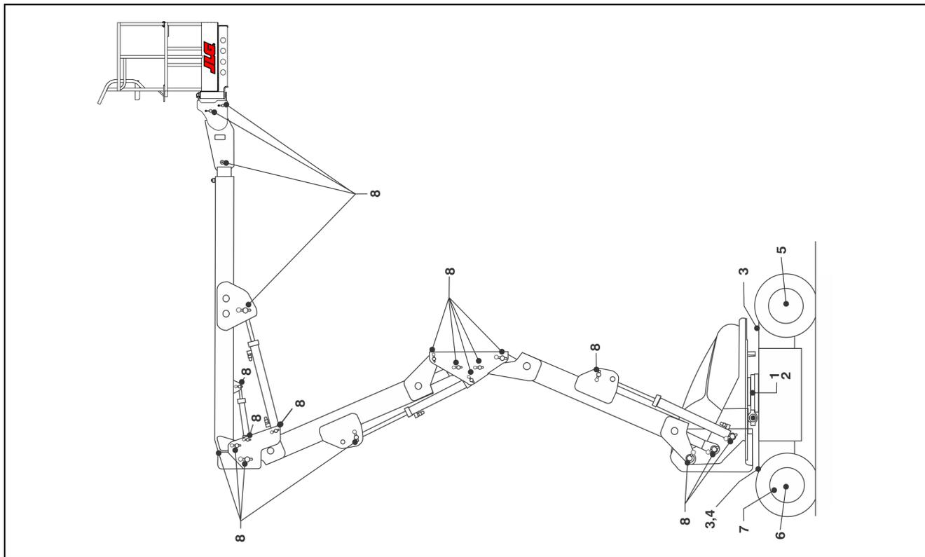
Figura 7-2. Diagrama de mantenimiento y lubricación de la E450
