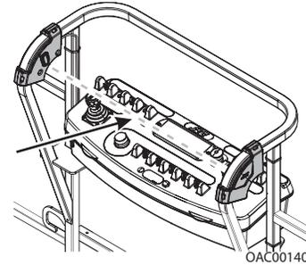
El operador pasa a través de la trayectoria del haz del sensor.
