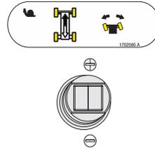
Si se coloca el interruptor de dirección hacia la derecha o la izquierda, la máquina vira hacia la derecha o la izquierda, respectivamente.
