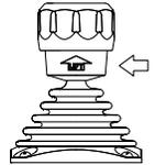
**NOTA:** La palanca de control de elevación/giro de pluma principal está bajo tensión de resorte y retorna automáticamente al punto muerto (apagado) al soltarla.
