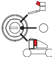
**NOTA:** Cuando el selector de controles de plataforma/suelo está en su posición central, se desconecta la alimentación de los dos puestos de control.
