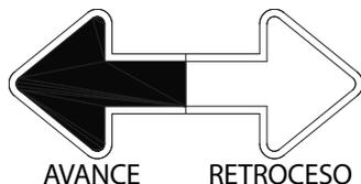
2. Pulsar y soltar el interruptor de anulación de orientación de mando. Antes de transcurridos 3 segundos, mover el control de mando motriz hacia la flecha que señala en el sentido que se desea propulsar la máquina. La luz indicadora destella durante el intervalo de 3 segundos, hasta que se seleccione la función de mando motriz.
