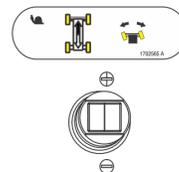
Esta máquina tiene un indicador de orientación de mando. La luz amarilla de la consola de controles de plataforma indica que se ha girado la pluma más allá de las ruedas motrices traseras y que el mando motriz/dirección de la máquina puede responder en sentido opuesto al movimiento de los controles. Si el indicador se ilumina, accionar la función de mando motriz de la manera siguiente:
