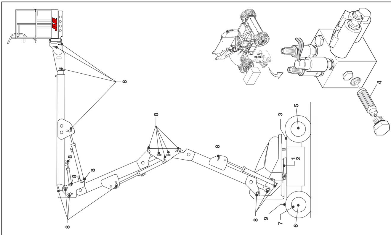
**Figura 7-3. Diagrama de mantenimiento y lubricación de la M450**
