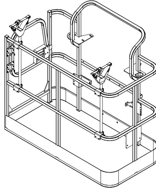
Los soportes para tubería proporcionan un medio para almacenar tuberías o conductos dentro de la plataforma a fin de evitar que las barandillas se dañen y optimizar el uso de la plataforma. Este accesorio consta de dos soportes con correas ajustables para asegurar la carga en su lugar.
