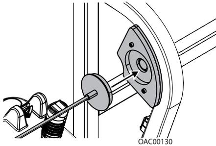
Volver a conectar el extremo magnético del cable al soporte si se desconecta.
