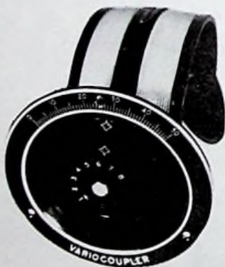
EISEMANN VARIO-COUPLER SWITCH POINTS INSIDE
