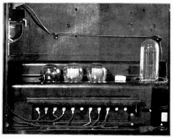
Figure 12-The Rectifier-Power-Amplifier unit
