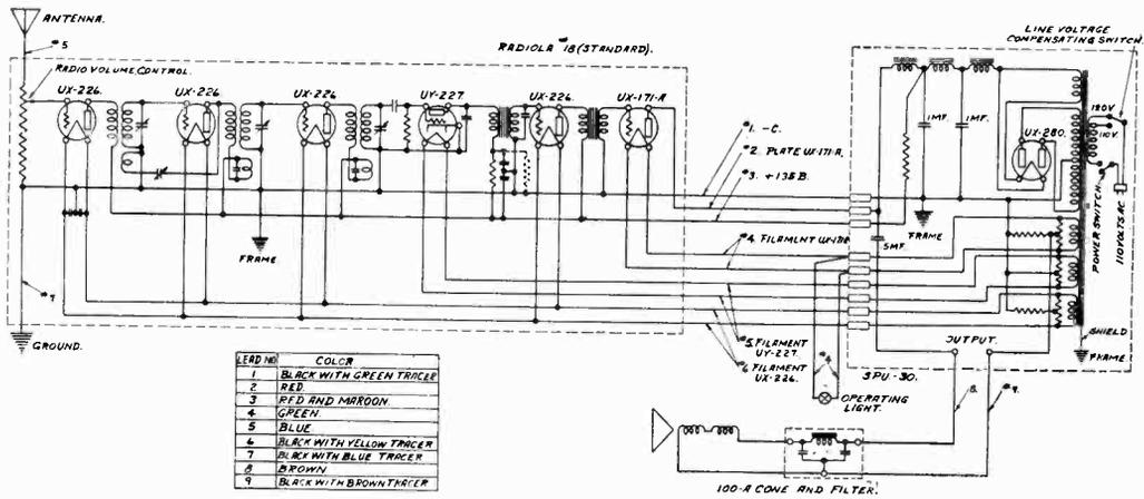
**Wiring Diagram Victor Radiola 18**
