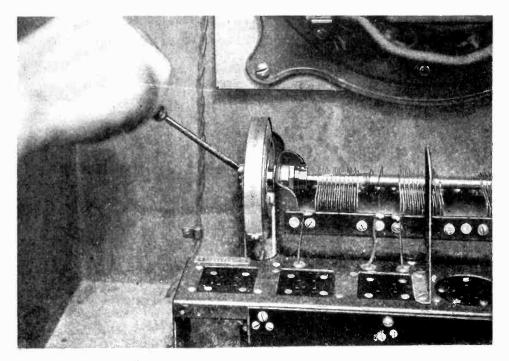
Figure 5—Tightening condenser drive cable
