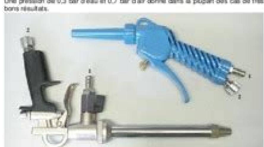
Pistolet métallique : ouvrir l'eau avec le robinet intégré puis appuyer sur la poignée pour générer le jet de brouillard à l'aide de l'air.
