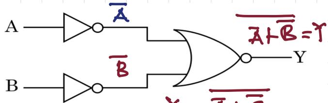
$$Y = \overline{\overline{A} + \overline{B}}$$
